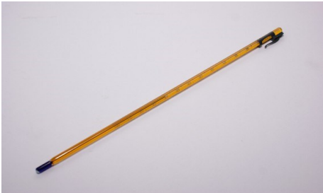
Thermomètre à liquide rouge -20 +110 °C
