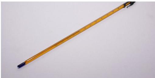
Thermomètre à liquide rouge -20 +110 °C
