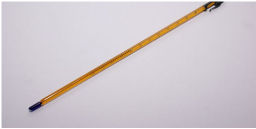
Thermomètre à liquide rouge -20 +110 °C
