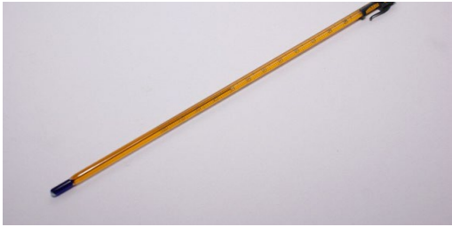
Thermomètre à liquide rouge -20 +110 °C
