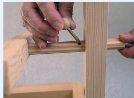
Fig. 4 : Petite goupille permettant de bloquer l'axe où est posé le plan incliné
