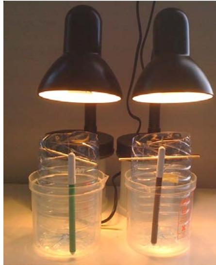
Lorsque les élèves arrivent dans la salle, il demande à chaque groupe de se placer face au montage déjà préparé. Il leur demande de préciser ce que représente la lampe (Soleil), la bouteille en plastique (l'atmosphère), Il précisera que le grand bocal en plastique ne sert qu'à stabiliser le dispositif pour éviter que la bouteille en plastique ne se renverse. Il leur demande par la suite ce que contient l'atmosphère (de l'air).
